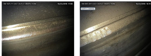
DCSS Visual Inspection – Lid Weld
